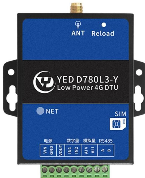
YED-D780L3-Y DTU 是由银尔达 (yinerda) 推出的高性价比的低功耗 DTU，适合设备控制，状态检测，传感器数据采集等通过 4G 网络与服务器通讯的场景，特性如下：
