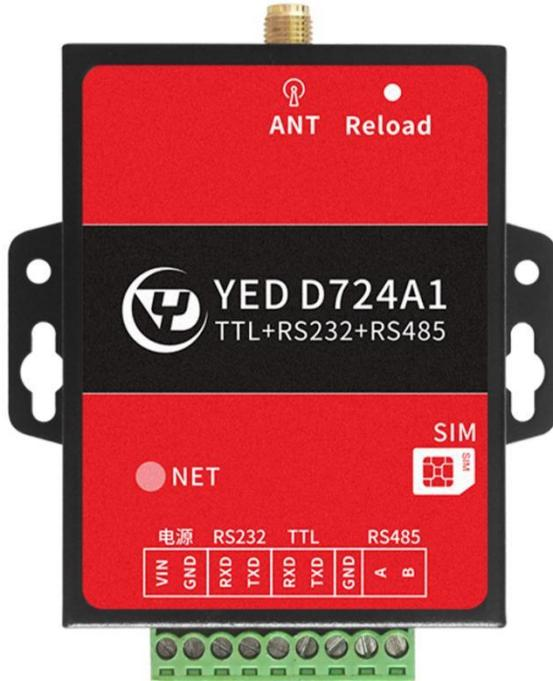
YED-D724A1 DTU 是由银尔达（yinerda）推出的工业级的 4G Cat1 DTU。小巧、稳定、可靠。适合设备控制，状态检测，传感器数据采集等通过 4G 网络与服务器通讯的场景，特性如下：
