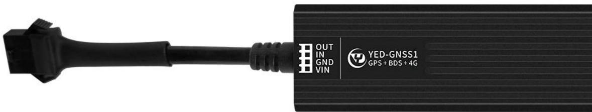
YED-GNSS1 DTU 是由银尔达（yinerda）推出的高性价的带 GPS/北斗定位+4G Cat1 通信的 DTU，适合设备控制，状态检测，传感器数据采集等通过 4G 网络与服务器通讯的场景，特性如下：
