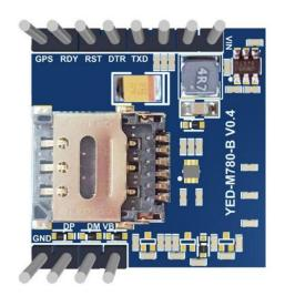
YED-M780 系列 DTU 是由银尔达(yinerda)推出的工业级的单 TTL 串口 DTU 。小巧、稳定、可靠。适合设备控制,状态检测,传感器数据采集等通过 4G 网络与服务器通讯的场景。分为 4 个大版本 YED-M780-B( $5^{-12V}$  供电,不支持 GPS),YED-M780G-B( $5^{-12V}$  供电支持 GPS),YED-M780-C( $3.3^{-4}.2V$  供电,不支持 GPS),YED-M780G-C( $3.3^{-4}.2V$  供电,支持 GPS),特性如下:
