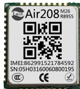
Air208M 是一款超小的四频 LCC 封装 GSM/GPRS 模块, 尺寸仅为 15.8mm×17.7mm×2.3mm, 最大限度地满足终端产品对小尺寸模块产品需求, 有效帮助客户减小产品尺寸并优化产品成本。Air208M 在设计上完全兼容移远 GPRS 系列 M26 模块, 方便客户快速、灵活的进行产品设计和升级。
